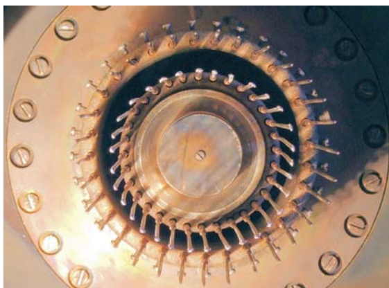
Rys. 4.1.4. Fotografia wieloprętowych elektrod i impulsowego zaworu gazowego, wykonana wzdłuż osi symetrii układu RPI-IBIS.
