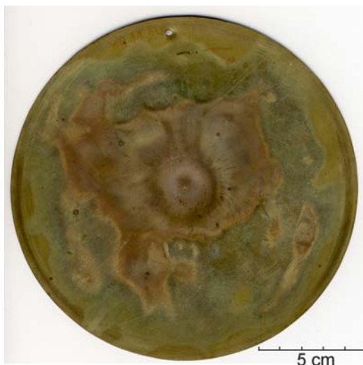
Rys. 5.4.7. Fotografia erozji powierzchni tarczy wykonanej z miedzianej blachy, którą umieszczono na osi układu RPI-IBIS (w odległości 22 cm od końców elektrod) i naświetlono podczas jednego wyladowania.
