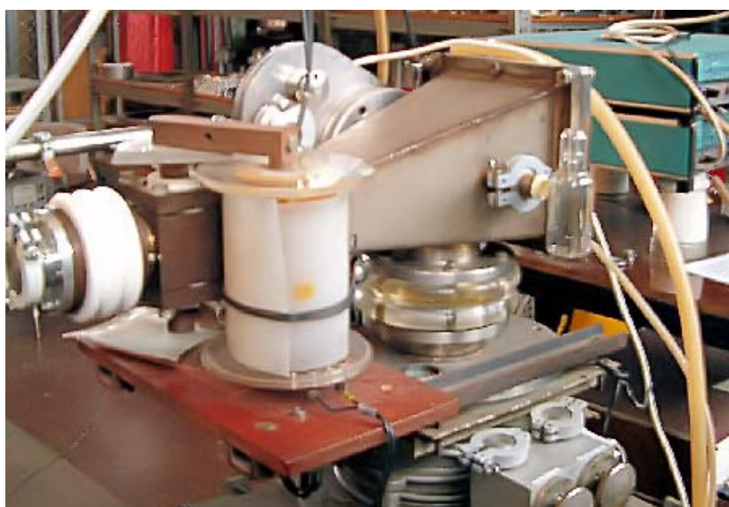
Rys. 4.2.2. Fotografia spektrometru Thomsona, zbudowanego w Świerku i stosowanego m.in. do pomiarów przedstawionych w niniejszej pracy.
