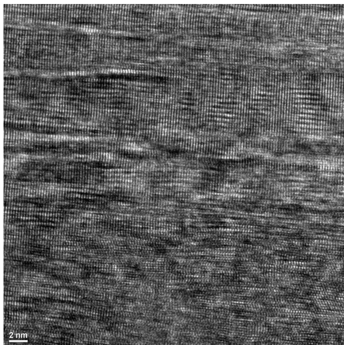
Rys. 7.1.2.15. Zdjęcie uzyskane przy pomocy metody HRTEM dla warstwy epitaksjalnej GaN bombardowanej dawką 1 \cdot 10^{17} at/cm 2 o energii 320 keV. Powiększenie zdjęcia wynosi 620kx.
