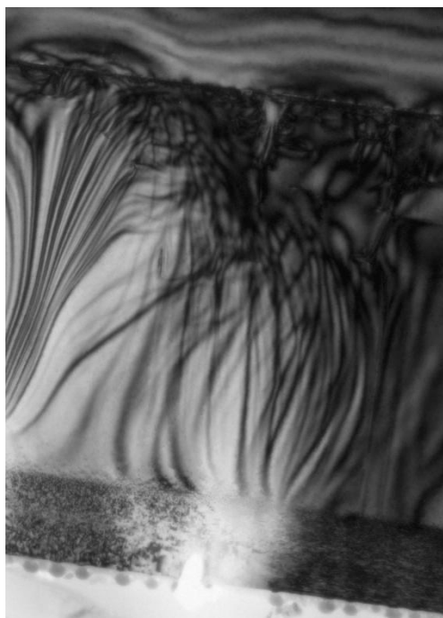
Rys. 7.1.2.10. Zdjęcie uzyskane przy pomocy metody HRTEM dla warstwy epitaksjalnej GaN bombardowanej dawką 6 \cdot 10^{16} at/cm 2 o energii 320 keV. Powiększenie zdjęcia wynosi 8kx.
