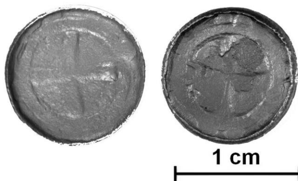
Rysunek 42. Moneta rdzeniowa. Testowa Moneta A. Denar krzyżowy typ VI odmiana CNP 858, pochodzenie polskie. W centralnej części monety po prawej stronie widać obszar z odsłoniętym rdzeniem.
