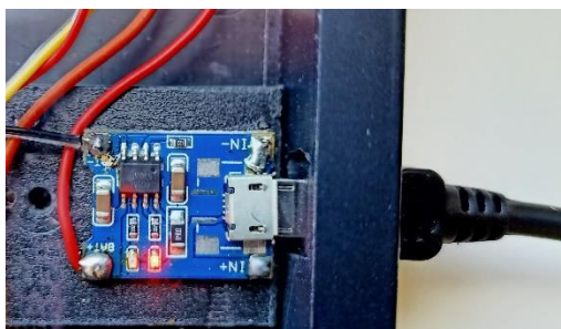
Rys. 7. Sygnalizacja ładowania Licznika za pomocą czerwonej diody.
