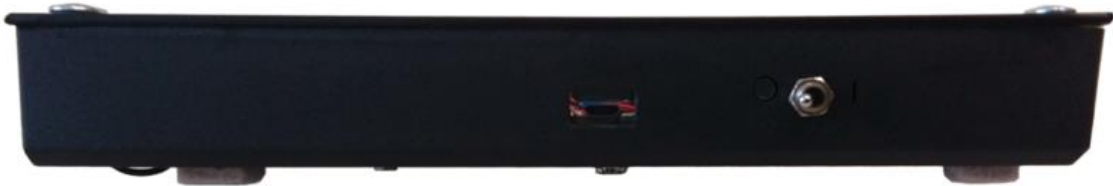
Rys. 2. Prawa ścianka Licznika z widocznym włącznikiem i złączem microUSB.
