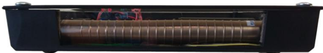
Rys. 4. Okienko detektora widoczne na przedniej ściance Licznika.
